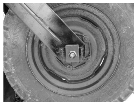
Рисунок 4.4 Крепление переднего колеса на каретке.
