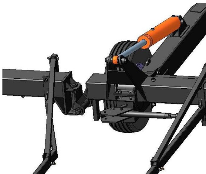
Рисунок 4.14. Правильное положение шарнира при сборке. Сцепка в рабочем положении. (Задняя проушина центрального бруса не показана)
